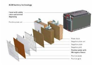
Les batteries étanches (VRLA) AGM est l'abréviation de Absorbent Glass Mat. Dans ces batteries, l'électrolyte est absorbé par capillarité dans une natte en fibre de verre placée entre les plaques. Les batteries AGM sont plus aptes à fournir des courants très élevés pendant de courtes durées (démarrage) que les batteries Gel. Ils sont principalement destinées aux Alimentations Sans Interruption (ASI).
